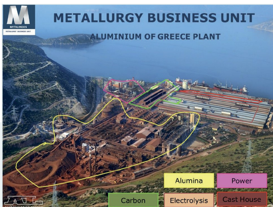
Figura 15: Elemente principale ale fabricii AoG și ale fabricii de co- generare pe bază de gaz natural
