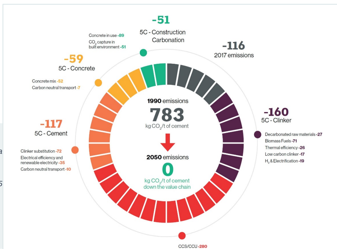
Figura 2: CEMBUREAU Planul de dezvoltare a reducerii emisiilor de CO 2 în cadrul lanțului valoric al cimentului (5 elemente: clincher, ciment, beton, construcții, re- carbonizare)
