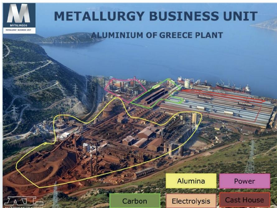
Ovaj ogledni primjer RE4Industry fokusira se na tvornicu aluminija u Grčkoj (AoG), koja je dio Metalurške poslovne jedinice tvrtke MYTILINEOS. AoG je najveći vertikalno integrirani proizvođač glinice i aluminija u Europskoj uniji s godišnjim proizvodnim kapacitetom od 900 kt glinice i 222 kt aluminijskih proizvoda (192 kt primarnog aluminija + 30 kt recikliranih frakcija).
